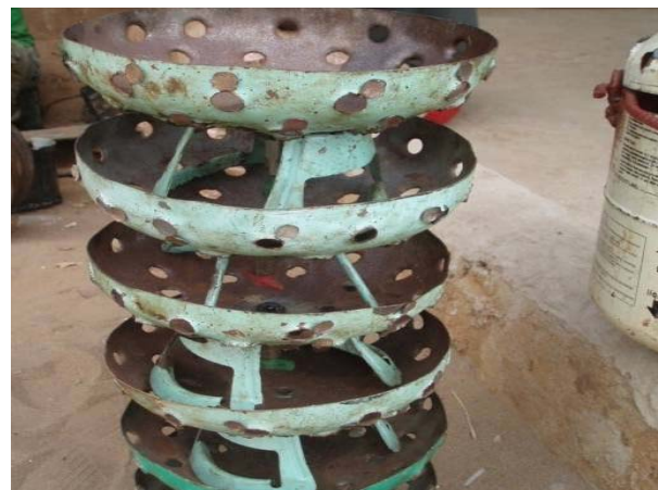
Figure 17: Foyers à charbon fabriqués à l'aide de bouteilles de gaz de réfrigérateurs
